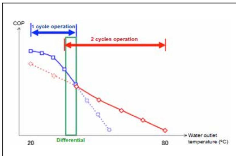
Επιπλέον, αυτός ο καινοτομικός διαδοχικός κύκλος των Yutaki S80, οδηγεί και σε αρκετά καλύτερο βαθμό απόδοσης COP, καθώς αξιοποιεί τις καλύτερες συνθήκες λειτουργίας και απόδοσης κάθε στιγμή.
